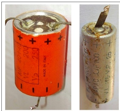
Fig. 5 – Questi elettrolitici mostrano segni evidenti di fuoriuscita di elettrolito e vanno cambiati.
